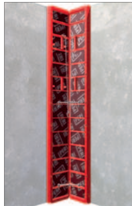
TRH innerhörn 420 med integrerade, inställbara spindlar 500 möjliggör snabb formrivning från betongen.
