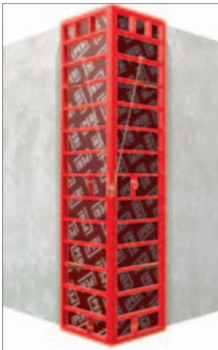
TRH ytterhörn 420 med 90 cm skänkelängd används utan formstag vid väggjocklekar på upp till 24 cm. Även här är kranfästet fast monterat på elementet.
