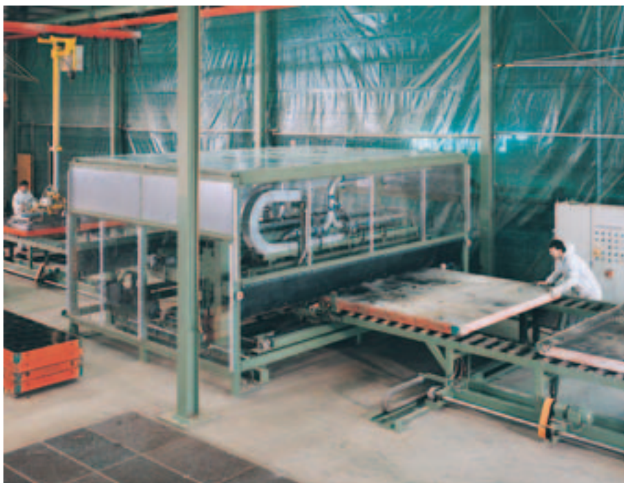
PERI rengöringsanläggning i drift.
