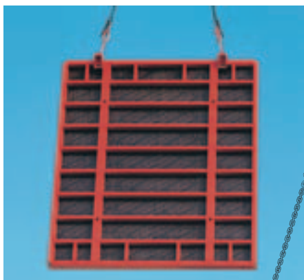
Kombilängan tillsammans med lyftredskapet vid formsättning.
