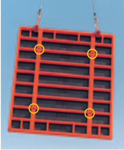
Storelement 270 x 240 med formstagshål innanför ramprofilen.
