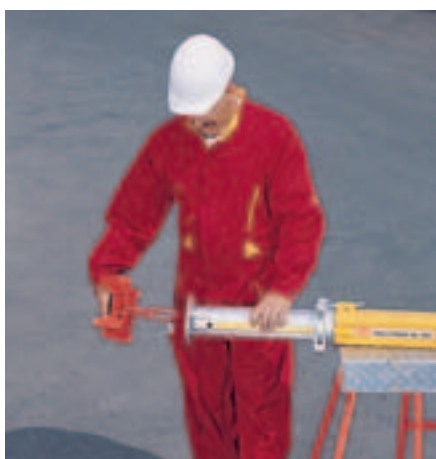
Systemdelarna med snäpplås för PERI valvformsystem passar på valvstämp med diameter Ø 40 mm ändhål.
