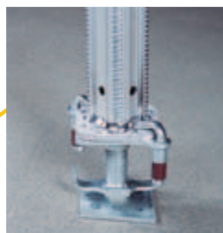
MULTIPROP ledad fot MKF För användning på lutande underlag, i kombination med ramar. Ledbar 3° runtom.
