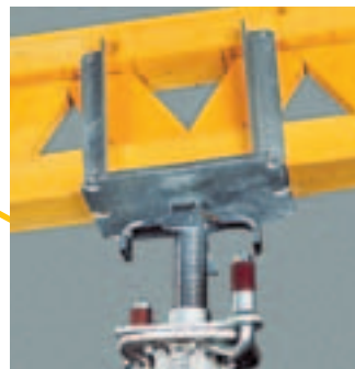
MULTIPROP ledat toppstycke MKK För tipsäker upptagning av en eller två balkar GT 24 resp. VT 20. Ledbar 3° runtom.
