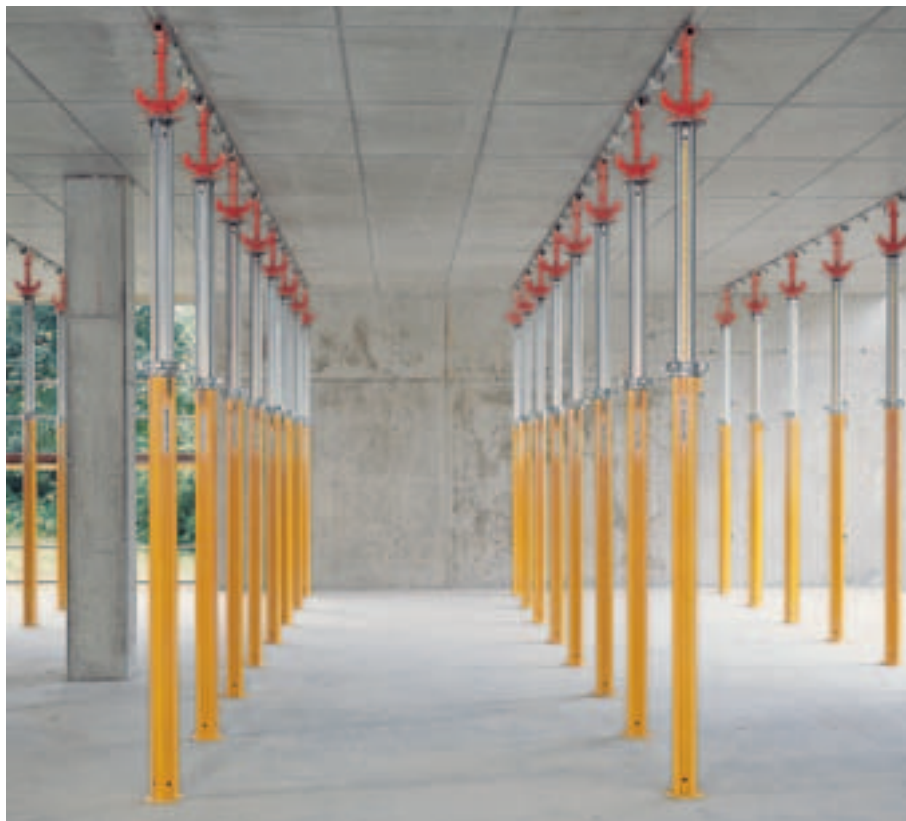
MULTIPROP 350 och SKYDECK valvform i avformat tillstånd. Bara 0,29 stämp/m 2 valvyta, upp till 40 cm valvtjocklek.
