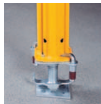
MULTIPROP ledad fot MKF För användning på lutande underlag, i kombination med ramar. Ledbar 3° runtom.
