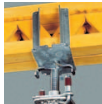
MULTIPROP ledat toppstycke MKK För tipsäker upptagning av en eller två balkar GT 24 resp. VT 20. Ledbar 3° runtom.
