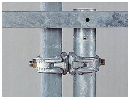
Enkel anslutning av ställningsrör Ø 48,3 mm med rörkoppling DK 1.
